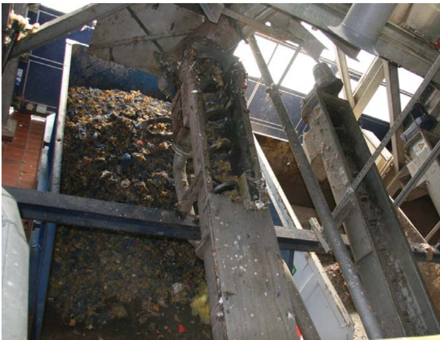
Photo 11 : Broyage et humidification de la matière avant flottation dans une usine de méthanisation de Strabag (technologie Linde) en Allemagne
