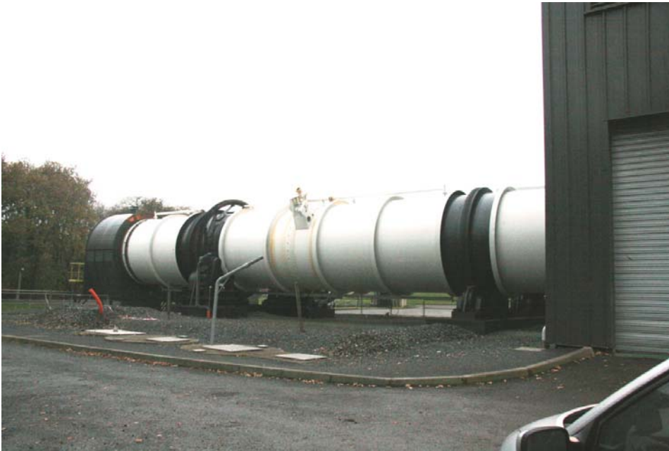
Photo 8 : Biostabilisateur de l'usine SMITOM à Launay-Lantic en France
