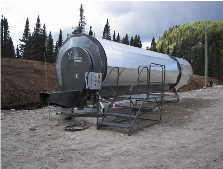
Photo 14 : Composteur AGF-Brome installé à La Romaine pour Hydro-Québec
