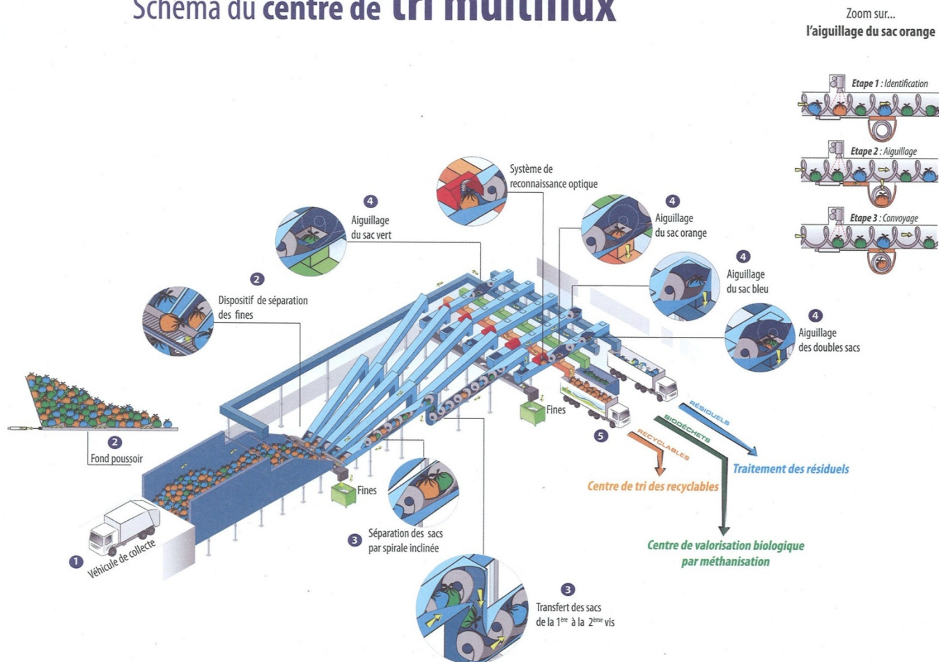
Figure 7 : Système de tri multiflux de la compagnie BagTronic
